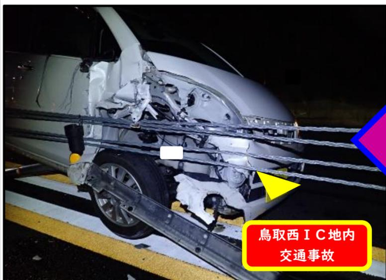
鳥取西IC地内に昨年度設置した「ワイヤーロープ式防護柵」箇所では、ワイヤーロープに接触する交通事故が多発していたため、「目立たせて接触防止」を目的に反射材を設置しました。
